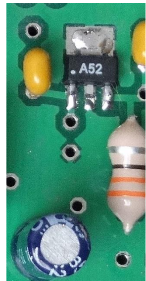
Fig. 30, Componentzijde (RX-voorversterker, SGA5289).
