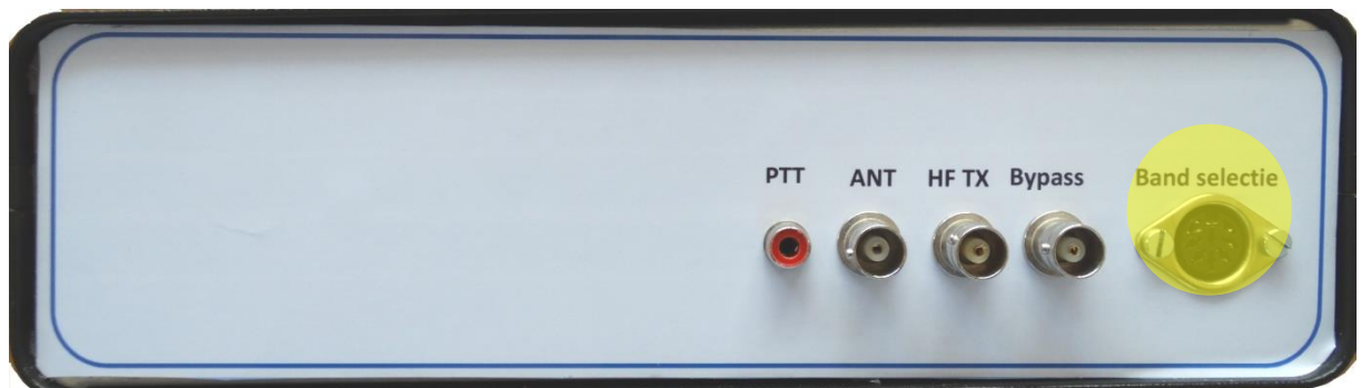
Fig. 64, Achterzijde LowPass Filter en PA-behuizing.
